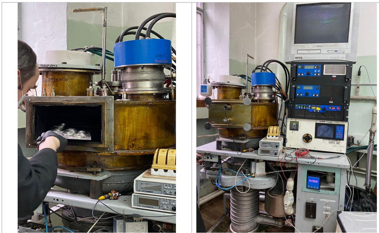
Рисунок 8 – а) Вакуумная камеры; б) Общий вид установки магнетронного распыления; магнетронами APEL-MRE100.
